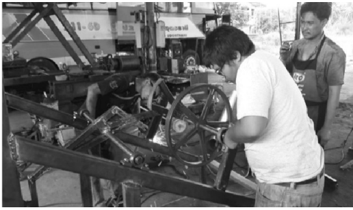
ภาพที่ 7 ติดตั้งเพลาตุ้กดสาก ใส่มุ่เลขขนาด 22 นิ้วเข้ากับเพลาสําหรับใส่สายพาน
