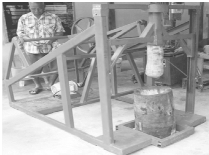
ภาพที่ 9 ชาวบ้านทดลองใช้เครื่องตำข้าวเม่าหลังปรับปรุง
