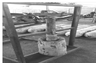
ภาพที่ 4 ประกอบขาทั้ง 2 ข้างสำหรับยึดตั้งเพล
